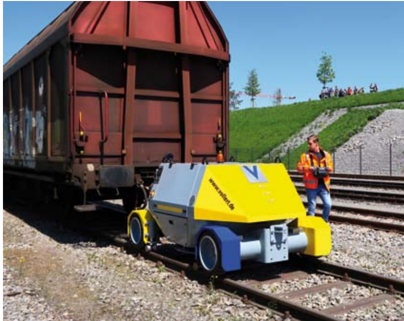
Kompakt, wendig, batteriebetrieben und abgasfrei: der neue Zweiwege-Robot VLEX von Vollert.
