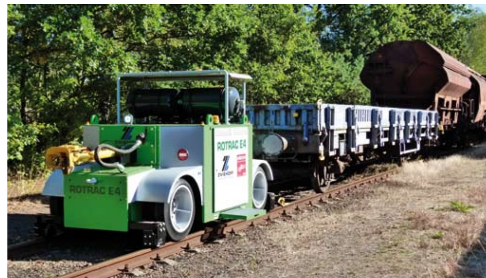
Zwiehoff ROTRAC E4 – elektrisches Rangiergerät.
