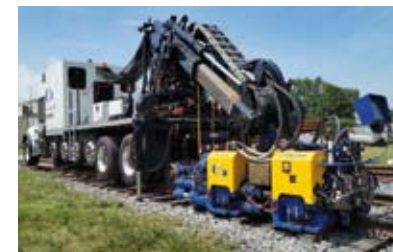
Im nordamerikanischen Markt sehen die zweigegefahrbaren Abbreinstumpfschweißmaschinen Plasser & Theurer APT 1500 RL allein schon wegen des Trägerfahrzeuges etwas anders aus.
