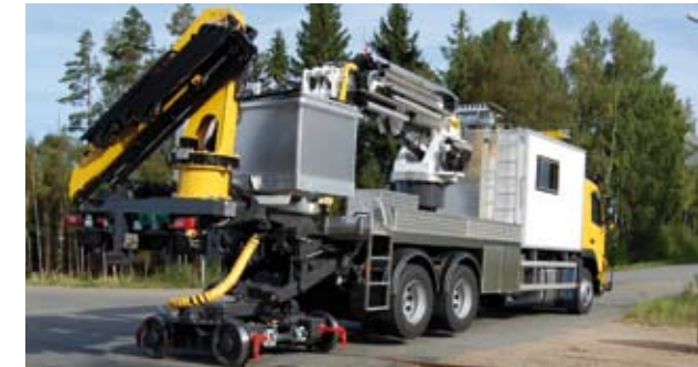
Schnelles und sicheres Ein- und Ausgleisen.
