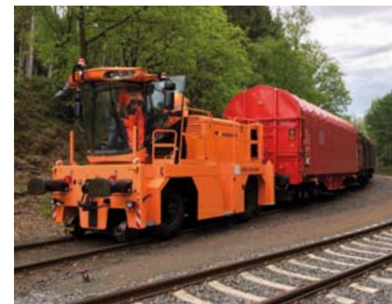
Akkuelektrisch angetriebener WINDHOFF ZRW125AEM.
