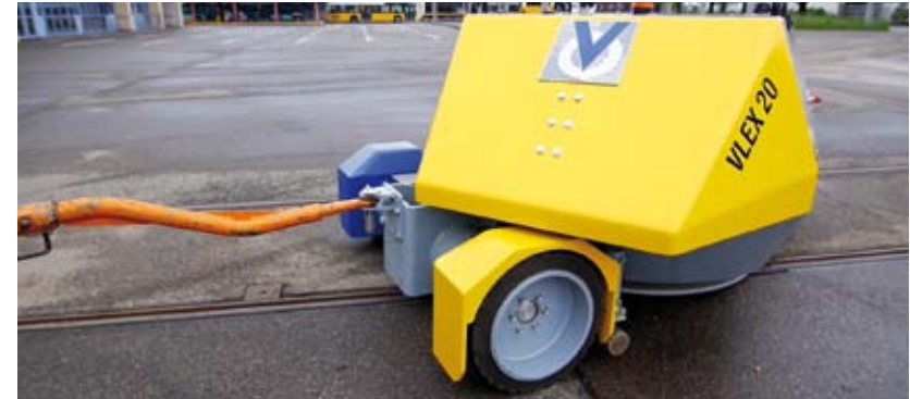
Die Nicklenkung erfolgt über die Drehzahlsteuerung der Radnabenmotoren und ermöglicht reifenschonende Wenderadien von nur 7,2 Metern.
