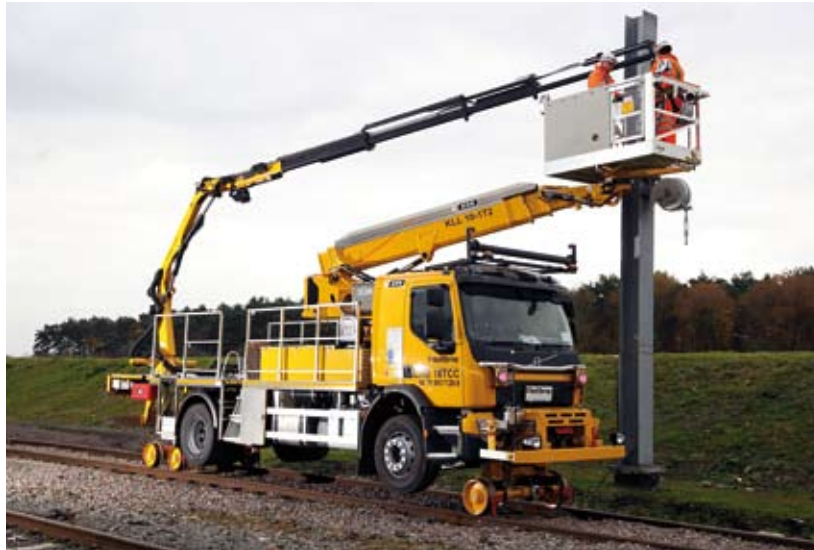
Zweiwege-Fahrzeug LRB 18 TCC mit Neigungskorrektur der Arbeitsbühne und zusätzlichem Kran.
