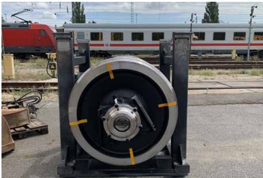
Radsatzlagerdeckel aus dem 3-D-Drucker – spart Zeit, Rohstoffe, Lagerkapazitäten und Transportwege.
