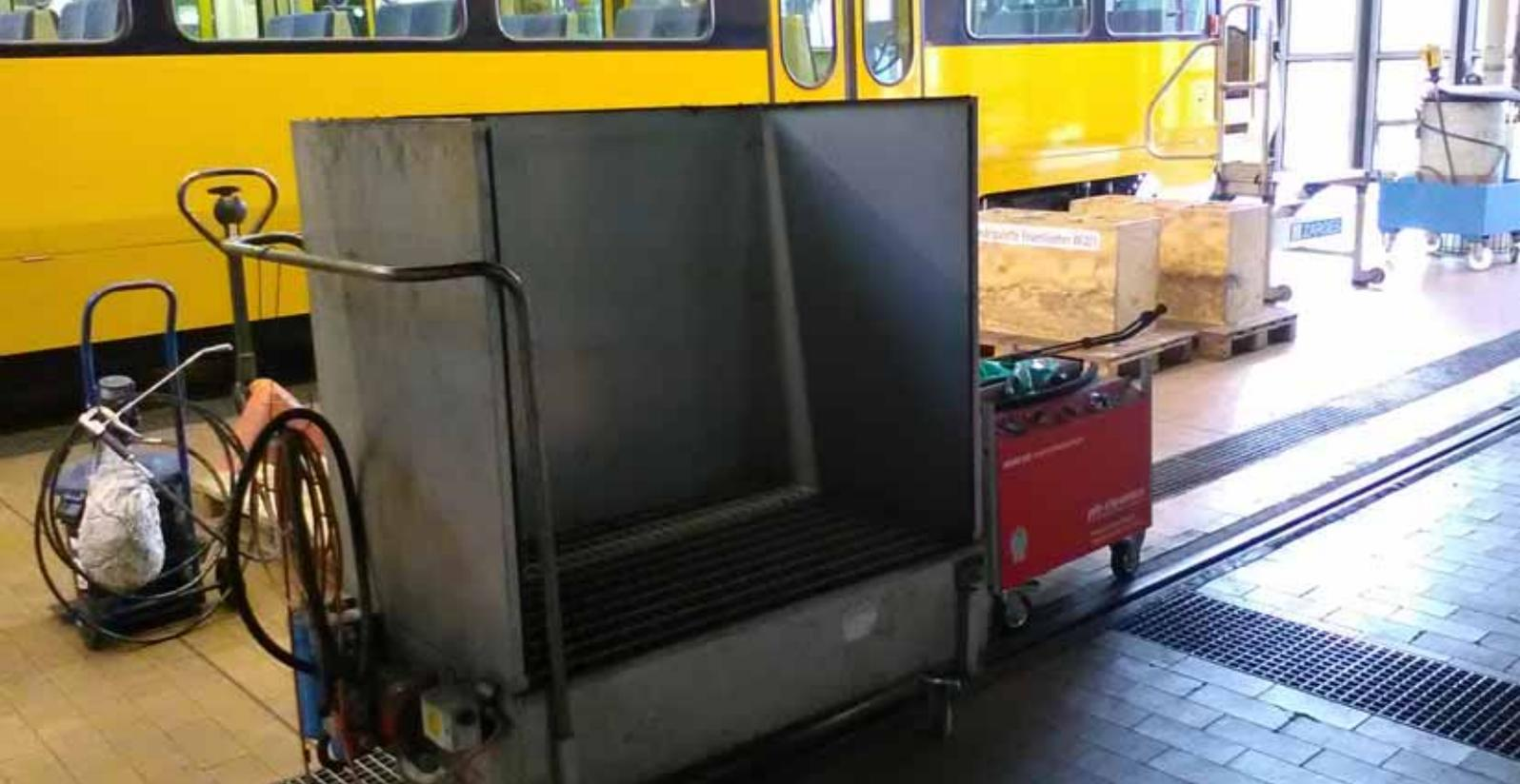
Die mit 60-Liter-Tanks bestückten mobilen Heißreiniger der ph-cleantec – hier mit einer Großwanne – können auch direkt unter Waggons operieren.
