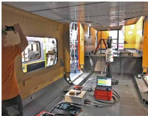
Abb. 2: Rohkarosse mit getrackten Punkten
