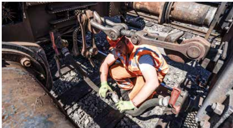
Rangierer beim Verbinden der Hauptluftleitung
