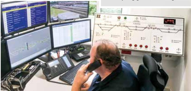
*FV-NE-Stellwerk mit automatisiertem Selbststellbetrieb mit Zuglenkreehner*
