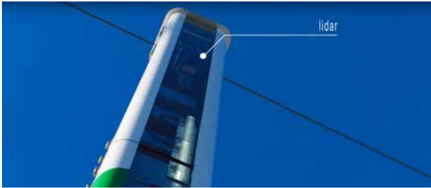
Im den Scannersäulen sind Hochgeschwindigkeitskameras und Lidar-Sensoren verbaut.
