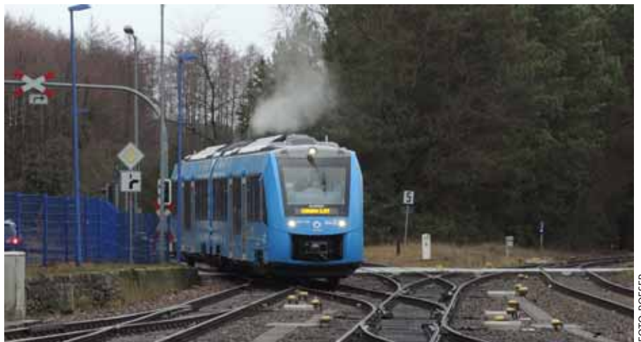
Macht Dampf, nicht Qualm: der Brennstoffzellen-LINT54 von Alstom.
