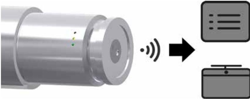
*Wahlweise kabelgebundene oder kabellose Übertragung an Führerstand oder an zentraler Stelle zur Flottenüberwachung*
