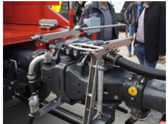
Auf der InnoTrans wurde manuelle Griffe für die DAK vorgestellt, die das Entkuppeln sicherer machen.
