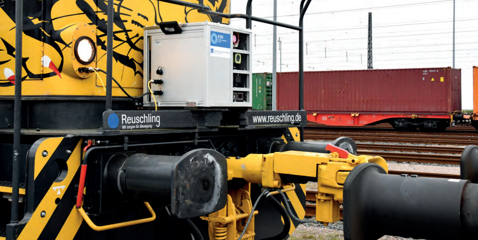
Der „Tiger“ wurde vom Lokomotiv-Hersteller Reuschling für die Vollautomatisierung umgebaut und in den JadeWeserPort überführt.
