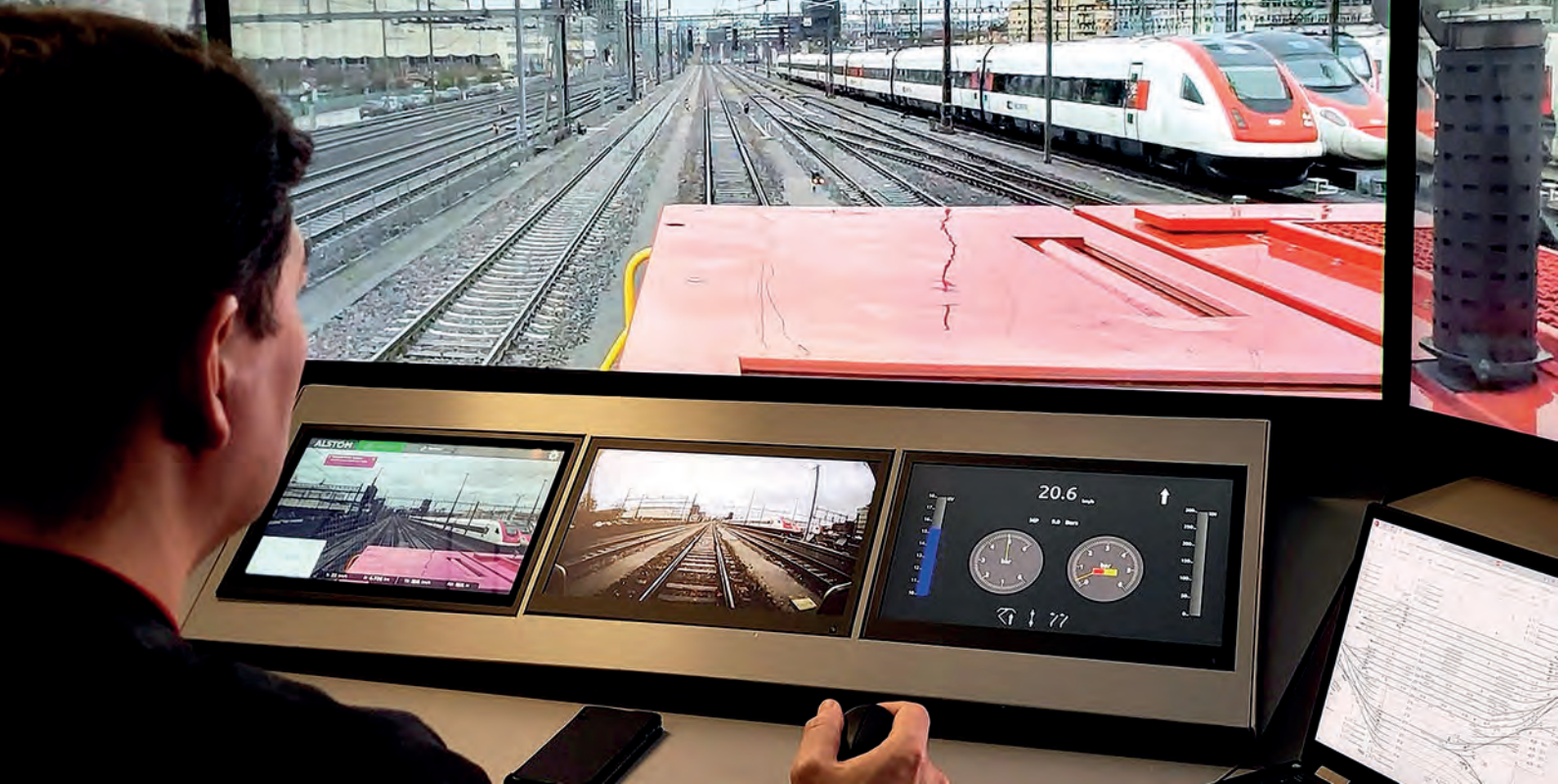
Die Fernsteuerung ermöglicht es, Triebfahrzeuge aus einem örtlich entfernten Kontrollraum bei Rangier- und Tunnelunterhaltsarbeiten oder Baustellen zu steuern. Im März 2024 wurden von Alstom und SBB gemeinsam erstmals Testfahrten im aktiven Betriebsumfeld durchgeführt.
