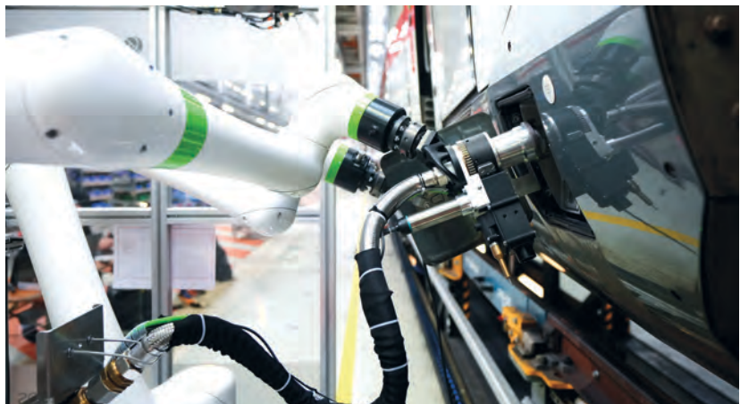
Cobot inklusive KI: Ein fahrbarer Roboter versorgt im ICE-Werk Köln-Nippes einen ICE mit Frischwasser und pumpt das Abwasser ab.
