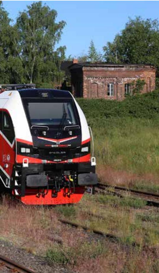
ELPs **brandneue Dual Lokomotiven** auf dem **neuesten Stand der Technik** garantieren eine **hohe Zuverlässigkeit und Verfügbarkeit!** Die sechsachsigen Hybridlokomotiven mit bis zu 2,8 MW Diesel, 9 MW elektrisch und 500 kN Zugkraft überzeugen in jeder Hinsicht. Sie ermöglichen den Betrieb auf elektrifizierten und nicht-elektrifizierten Strecken und **erhöhen Ihre Anhängelast um**
